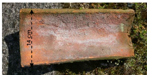
Exemple du modèle de tuile canal « tige de botte »
